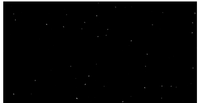
Die Bewegungen der Ruderfußkrebse werden mit einer Geschwindigkeit von 100 Bildern pro Sekunde bei einer Auflösung von 1.280 x 1.024 Pixeln aufgezeichnet. Die Ruderfußkrebse erscheinen als weiße Punkte auf dem schwarzen Hintergrund.
