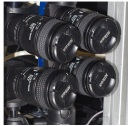
Der Aufbau des 3D-PTV Systems am Institut für Umweltströmungsmechanik. Die Versuchsanordnung arbeitet mit vier Mikrotron EoSens® Kameras.
