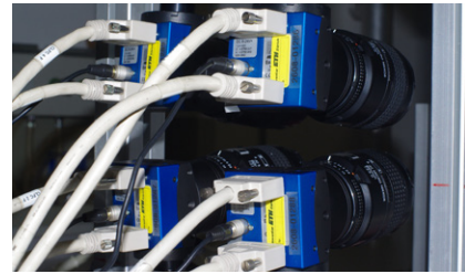
Der Aufbau des 3D-PTV Systems am Institut für Umweltströmungsmechanik. Die Versuchsanordnung arbeitet mit vier Mikrotron EoSens® Kameras.
